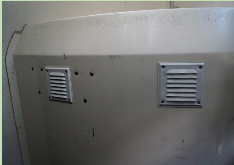
Warmluftauslasströmer an Stirnseite des Trailers
