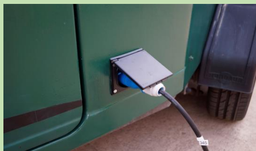
Ext. Stromzuführung bei langen Standzeiten
