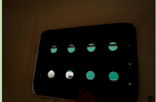
Seitenausstellfenster kann von Innen zusätzlich verdunkelt werden.
